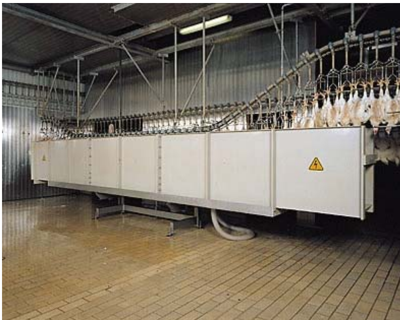
Figuur 3: Andere (hoog-frequentie) uitvoering van een elektrisch waterbadverdover. Foto gebruikt met permissie van Stork BV.
